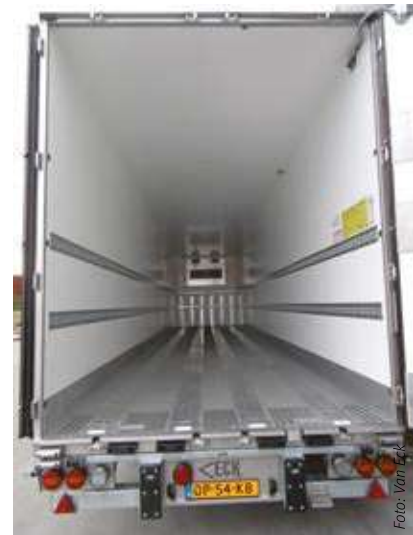
Das Rollbahnsystem gemäß IATA-Norm erleichtert die Verladung in dem Pharma-Trailer.
